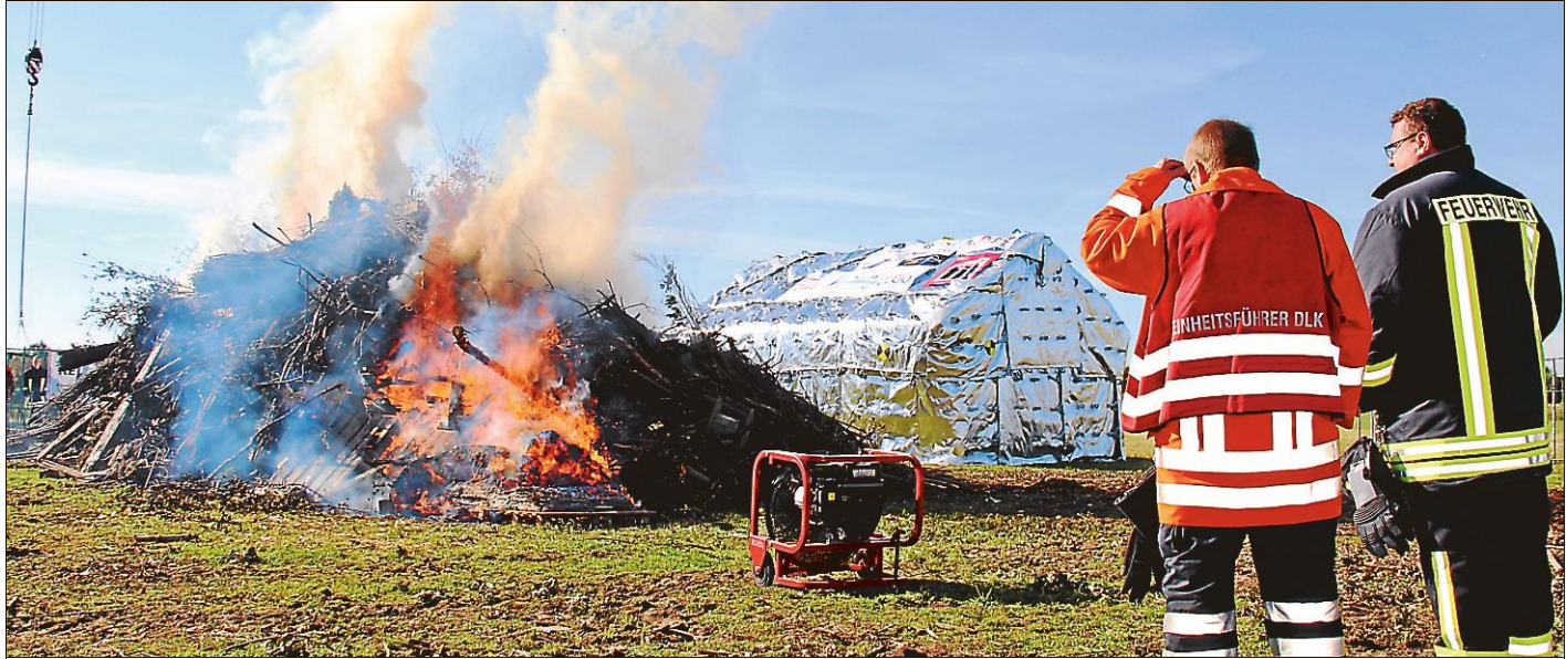
Ein fünf mal acht Meter großes Holzhaus wurde mit 40 Brandschutzmatten abgedeckt, direkt daneben brannte unter Kontrolle der Feuerwehr Wiesmoor ein Holzhaufen lichterloh, doch dank der Matten fing das Haus kein Feuer. BILDER: ANNA GRAALFS
